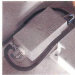
De batteryguard voorkomt dat uw accu leegloopt als u de motor stiltet, bijvoorbeeld tijdens een stop onderweg.
