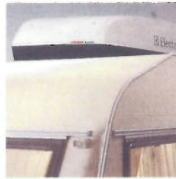
Traploos regelbare Electrolux airconditioner; capaciteit 1100 of 1500 Watt, incl. 800 Watt verwarmingselement.
